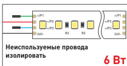
Схема 2. Подключение нескольких светодиодных лент с двух сторон
