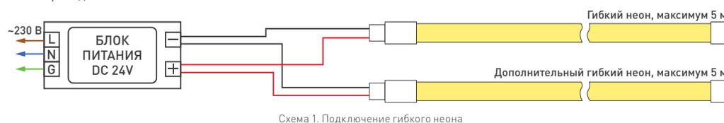
Схема 1. Подключение гибкого неона
